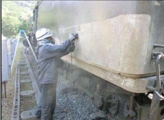
こちらはテンダー(炭水車)側面の塗膜剥離。大量の粉塵が舞っていますね。吸い込むと大変なので、防護装備をバッチリ決めています。
