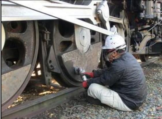
動輪部分の傷んだ塗装をグラインダーを使って剥離していきます。
