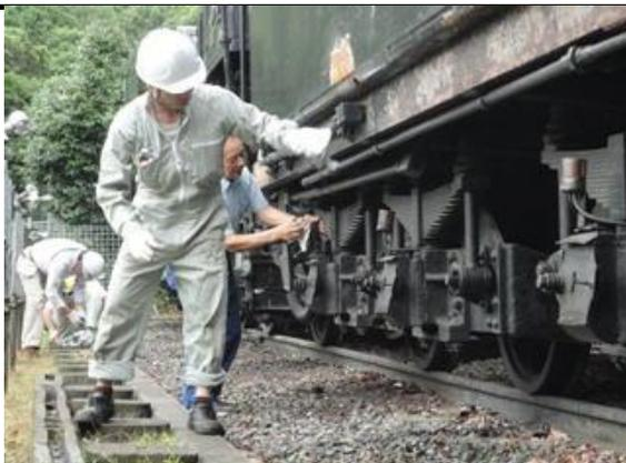
空模様と睨めっこしながらの磨き作業。一部塗装の剥げている部分は、傷みが目立ってきたため修復をかけている所です。
